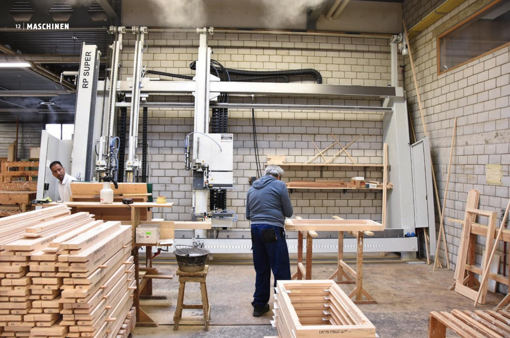
**FENSTERFERTIGUNG.** Rahmenpressen sind die grossen Brüder der weit verbreiteten Leimständer. Sie kommen insbesondere in der Fensterproduktion zum Einsatz. Neue Anlagen können von nur einer Person bedient werden, auch wenn grosse Elemente verleimt werden sollen.
